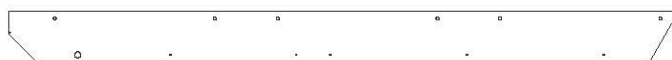
H28 CABIO DEL LADO DERECHO DEL TECHO - W4L18994 (x2) 1"x3 3/8"x42 1/8" (24x86x1069)
