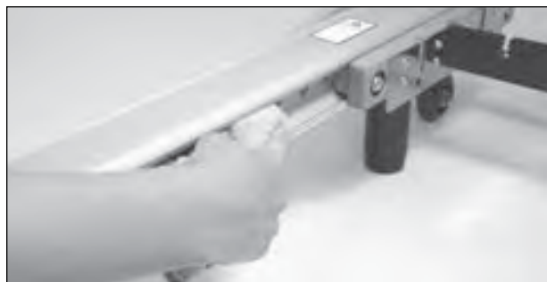
2. Limpie el interior del riel de aluminio con un paño seco para eliminar el polvo o la suciedad. Si utiliza un paño húmedo, rocíe el limpiador sobre el paño primero. Evite rociar el limpiador directamente sobre las superficies, los rodillos o los rieles de aluminio. Inserte el tope del carro en una de las seis posiciones.
