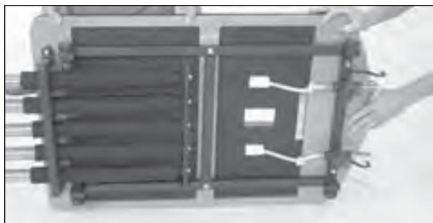
3. Asegúrese de que los elevadores de poleas sigan en el suelo, a cada lado de los rieles de aluminio. Cuidadosamente, voltee el carro sobre un lado, asegurándose de que los rodillos nunca entren en contacto con el suelo. Ahora, prepárese para que la otra persona sostenga el lado opuesto del carro.
