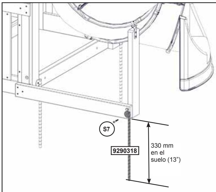
**!** ¡Advertencia! A fin de evitar que la estructura vuelque y prevenir posibles lesiones, las estacas deben clavarse a una profundidad de 330 mm (13"). Clavar las estacas o introducirlas en el suelo puede ser peligroso si no se comprueba antes la ausencia de conductores, cables o tuberías de gas subterráneos.
