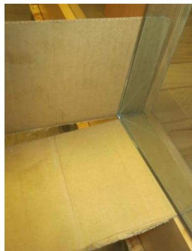
Cartón colocado vertical y horizontalmente entre la puerta de cristal y la jamba de la puerta
